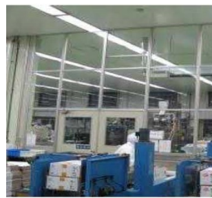
空気を経由した汚染の防止設備（パーティション）の導入
